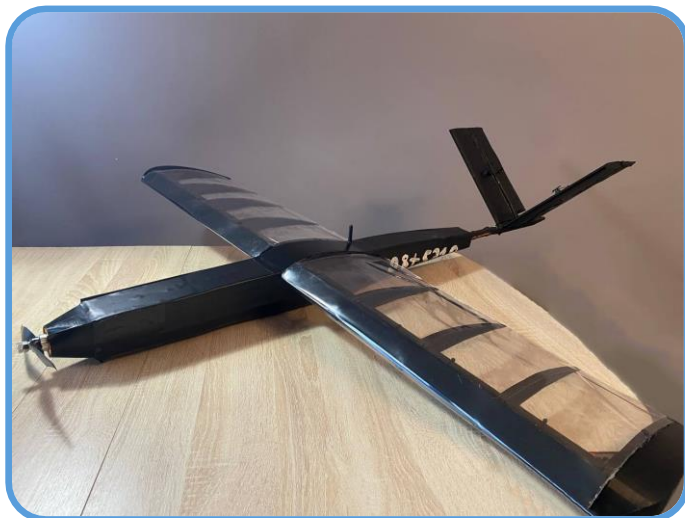
Рис. 1. Опытный образец БПЛА для испытания работы крыла
